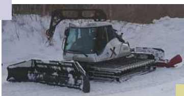
市で購入しスキー場へ貸与 しているゲレンデ整備車 (ウインチ付タイプ)
